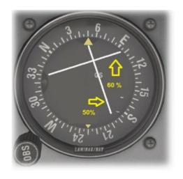
グライドスロープの追跡が自動的に行われない場合,パイロットはこれを手動で行うように強制することができます・上で概説したグライドスロープの装備に関する50%/60%の規則を満たした後。 ALT ボタンを押すと, ALTITUDE HOLD とGLIDESLOPE モードが同時に作動します。
