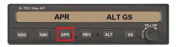
パイロットが APR (Approach) モードを開始したときにバーチャルグライドスロープ追跡が自動的に作動するようにするには,ローカライザーの逸脱が最大の50%以下でなければならず,航空機はグライドスロープの下になければなりません。
