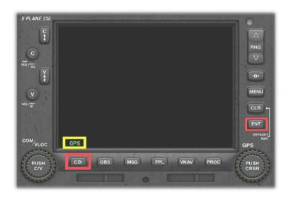
GPS デバイス (この例では GNS 530) にフライト プランをプログラムした 状態で, GPS モードを選択します。
