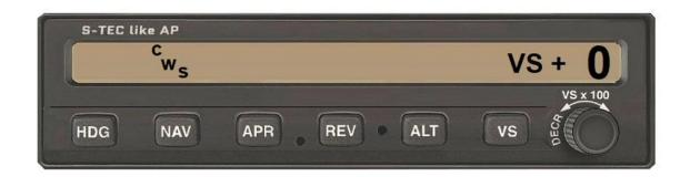
このモードでは、オートパイロットはエルロンおよびトリムの制御を一時停止し、パイロットがヨーク (操縦桿)で操縦できるようにします。
