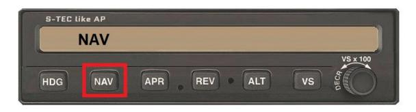
オートパイロットは, 45 度で希望のラジ アルをインターセプトする新しいコースを 確立します。
