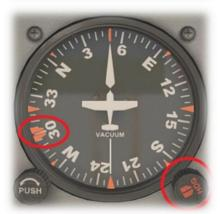
HDG (見出し) 指針を使用して、手動で希望のインターセプトコースを選択します。
