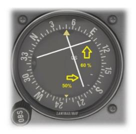
バーチャルグライドスロープ追跡が自動的に作動しない場合,パイロットはこれを手動で行うように強制することができます・上で概説したグライドスロープ装備の50%/60%ルールを満たした後。 ALT ボタンを押すと, ALTITUDE HOLD とGLIDESLOPE モードが同時に作動します。 グライドスロープをとらえると,ALTTITUDE モードは自動的にキャンセルされ,オートパイロットはグライドスロープを追跡します。
