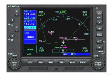
この章では、GPS 操縦モードが有効であり、パイロットがフライトプランの一部として LPV アプローチを選択したと仮定します。
