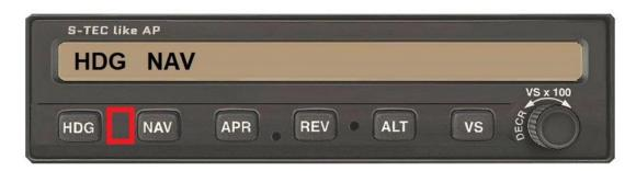
ラジアル方向のインターセプトが発生する と,コースインジケータが中央に移動し始め ます。
