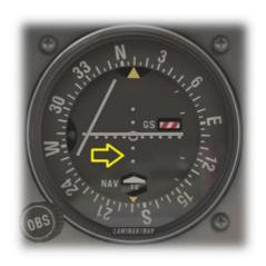
HDG モードの表示がディスプレイから消える とすぐに、(航空機が HSI を装備していない限 り)パイロットは HDG (Heading) 指針を VOR の方角に変更しなければなりません。
